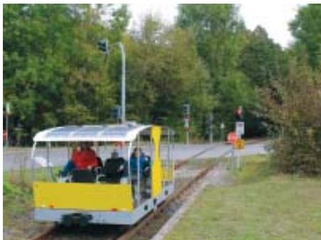
*Anders als bei anderen Draisinenbahnen genießen die Solar-draisinen Vorrang an den Bahnübergängen. Sogar zwei neue Sicherungsanlagen wurden eingerichtet.
