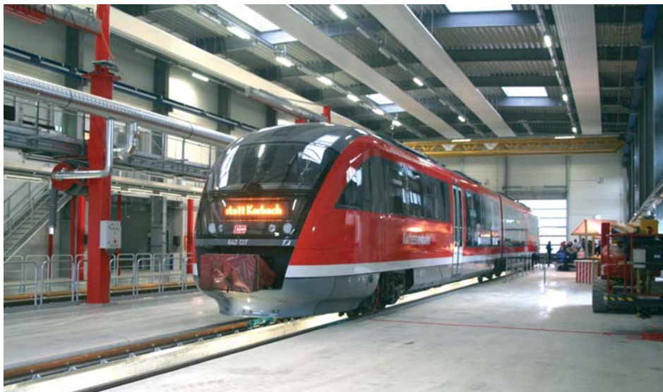
Als erster Triebwagen steht 642 137/642 637 zur Zugtaufe in der neuen Werkstatt der Kurhessenbahn auf dem Gleis für größere Reparaturen. Das Wartungsgleis dahinter verfügt über eine Untersuchungsgrube und zwei Arbeitsbühnen. Die silberfarbene Rohrleitung gehört zur Abgas-Absauganlage. Foto: Jürgen Schmied
