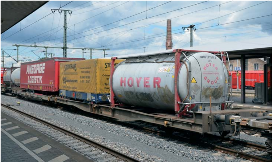
Ein Beispiel, wie der Umschlag zwischen Straße und Schiene gelingen kann: Eingereicht in einen Güterzug von Hamburg nach Norditalien, transportiert er einen Tankcontainer, eine Wechselbrücke und einen Sattelaufleger. Alle drei Transportbehälter sind genauso gut auch auf der Straße anzutreffen. Foto: Patrick Rehn
