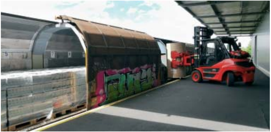
Während mehrere Tonnen schwere und bis zu 2,8 m breite Papierrollen mit Spezialgreifern und Stapler entladen werden, ist ein anderer Waggon bereits mit Ware in Richtung Skandinavien versandbereit. Foto: Günther
