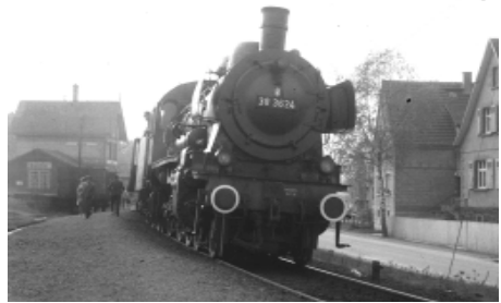
Bahnhof Mainzlar um 1959: Die Schlepptenderlokomotive der Baureihe 38 hat mit ihrem Personenzug einen Halt eingelegt. Erkennbar ist, dass es sich beim Personenwagen hinter der Dampflok um einen alten preußischen Abteilwagen handelt - offenstehende, nach unten gebogene Türen.
