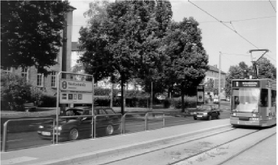
Behindertengerechte Zugänge und niedrige Bahnsteige, trotzdem leichtes Einsteigen dank Niederflurstraßenbahn, gute Haltestellenbeschilderung: Kassel macht das Straßenbahnfahren leicht!
