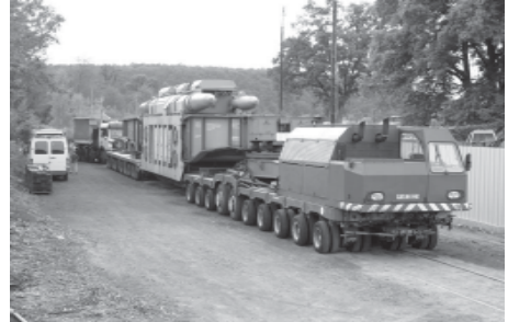
Der Trafoschwertransport bei Kerkerbach Foto: Hans-Peter Günther
