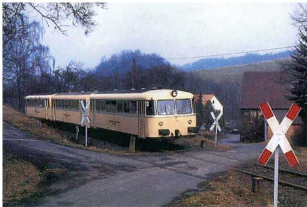
Einzelgänger auf deutschen Schienen: Schienenbus VT54/VM56/VS55 der HEG mit Faltenbalgübergängen
